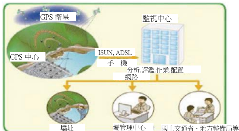
圖 22-3-9 GNSS 壩變形量測系統概念圖
